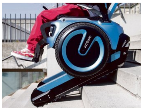
Massarbeit: Die zwei Raupen platzieren sich zentimetergenau auf den Treppenstufen. Patrick Gutenberg / Ex-Press
